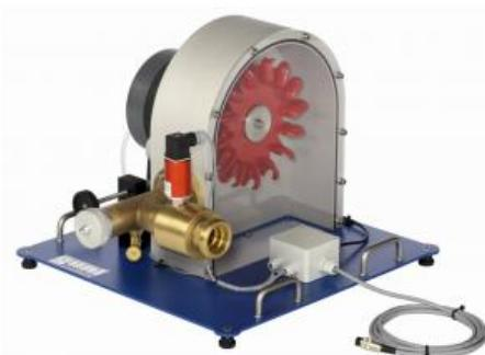
La turbine Pelton fait partie des turbines à jet libre qui transforment l'énergie de pression de l'eau en énergie cinétique entièrement au sein du distributeur.
