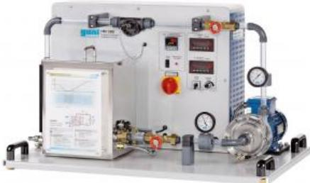
Les objets en mouvement rapide dans l'eau comme les roues d'une pompe centrifuge constituent l'une des causes les plus fréquentes des phénomènes de cavitation.
