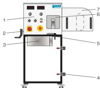
1 éléments d'affichage et de commande, 2 broche du dispositif de tension de la courroie trapézoïdale, 3 résistance de charge, 4 fermeture à genouillère, 5 levier de blocage du dispositif de tension, 6 trappe de service transparente, 7 tôle de protection de la courroie trapézoïdale
