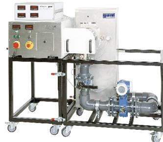
1 éléments d'affichage et de commande, 2 broche du dispositif de tension de la courroie trapézoïdale, 3 résistance de charge, 4 fermeture à genouillère, 5 levier de blocage du dispositif de tension, 6 trappe de service transparente, 7 tôle de protection de la courroie trapézoïdale
