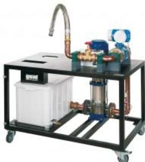
Avec l'unité d'alimentation HM 365.32, associée à HM 365.31, il est possible de faire fonctionner et d'étudier le comportement caractéristique de fonctionnement d'une turbine Pelton et d'une turbine Francis.
