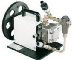
Il existe des pompes à palettes à volume de refoulement constant, et d'autres dont le volume de refoulement est ajustable. Elles sont composées d'un boîtier dans lequel tourne un cylindre excentré (rotor).
