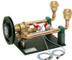
La pompe à engrenages se distingue par son débit de refoulement homogène.
