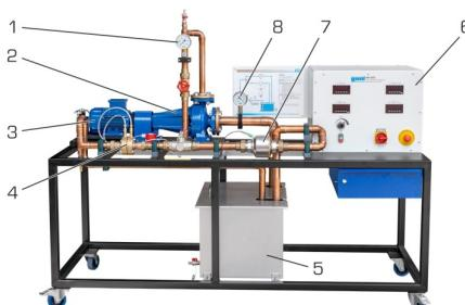
1 manomètre à la sortie, 2 pompe centrifuge, 3 moteur d'entraînement,
