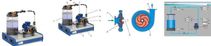
Pompes centrifuges et turbomachines utilisées pour l'acheminement de fluides.
