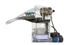
Les turbines à action travaillent selon le principe dégalité de pression. Les pressions statiques à lentrée et à la sortie du rotor sont égales.
