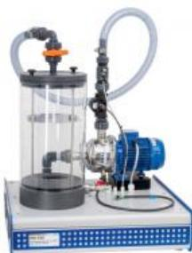
L'unité d'alimentation HM 290 est requise pour l'alimentation de diverses turbines. En plus, l'unité d'alimentation permet de réaliser des essais de base sur une pompe centrifuge.
