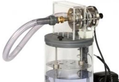
Les turbines à réaction et les turbines à surpression sont caractérisées par la transformation de l'énergie de pression en énergie cinétique dans le rotor.
