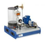
Les pompes à engrenages font partie du groupe des pompes volumétriques avec débit de refoulement continu. Deux engrenages tournant en sens inverse acheminent le fluide.
