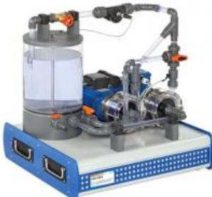
Dans les installations complexes, il est possible d'utiliser des pompes montées en série ou en parallèle. Les hauteurs de refoulement s'ajoutent pour le montage en série, et les débits de refoulement s'ajoutent pour le montage en parallèle.
