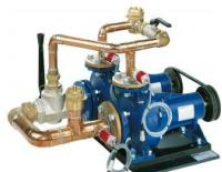
Dans des installations complexes, il est possible d'utiliser des pompes montées en série ou en parallèle. Dans le montage en série, les hauteurs de refoulement s'additionnent, tandis que dans le montage en parallèle ce sont les débits de refoulement des pompes qui s'additionnent.
