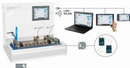
Dans l'écoulement des tuyaux, les surfaces, les géométries de section et la géométrie de la section dentrée influencent le frottement interne et donc aussi la formation de l'écoulement.
