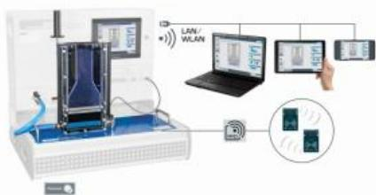
L'écoulement laminaire en deux dimensions dans le canal du HM 250.03 donne une bonne approche de l'écoulement des fluides idéaux, aussi appelé écoulement potentiel.
