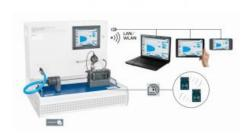
Le HM 250.02 est utilisé pour étudier le profil découlement. Il est ainsi possible de mesurer les différences dans la formation de lécoulement.
