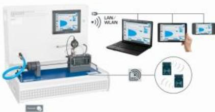
Le HM 250.02 est utilisé pour étudier le profil découlement. Il est ainsi possible de mesurer les différences dans la formation de lécoulement.
