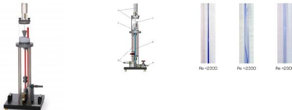
Un écoulement laminaire et un écoulement turbulent sont représentés durant lessai d'Osborne Reynolds.
