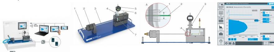
Le HM 250.02 est utilisé pour étudier le profil découlement. Il est ainsi possible de mesurer les différences dans la formation de lécoulement.
