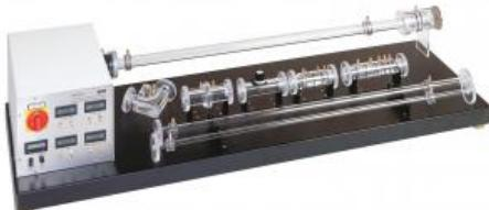
La densité des fluides compressibles varie en fonction des variations de la pression de l'écoulement. Les écoulements dont la vitesse est inférieure à Ma 0,3 sont considérés comme étant incompressibles. La variation de la densité est alors négligeable.
