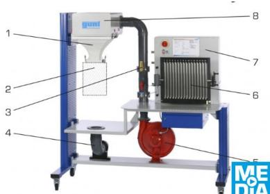
1 buse, 2 section de mesure à monter, 3 thermomètre, 4 tuyau d'air extract, 5 ventilateur radial, 6 manomètre à tubes, 7 coffret de distribution avec ajustage de la vitesse, 8 chambre de stabilisation avec redresseur d'écoulement
