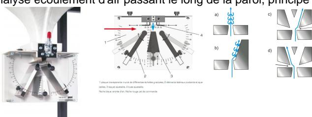
L'effet Coanda est le résultat de l'attraction d'un jet de fluide par une paroi convexe voisine, suivie d'une modification de la direction d'écoulement originale.
