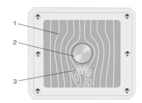
corps de résistance, 3 décollement de l'écoulement avec tourbillons
