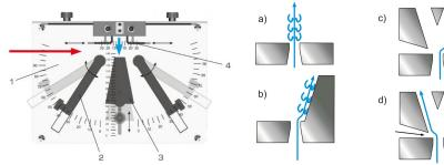
1 plaque transparente munie de différentes échelles graduées, 2 éléments latéraux pivotants et ajus
