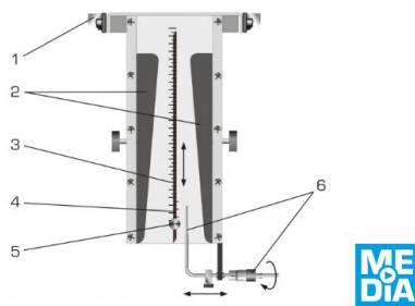
1 raccord rapide pour connexion sur HM 225, 2 corps latéraux démontables, 3 échelle graduée, 4 plaque avec différentes surfaces, 5 ajustage vertical de la plaque, 6 tube de Pitot avec vis micrométrique pour l'ajustage horizontal
