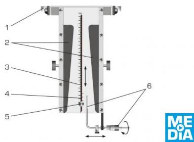
1 record rapide pour connexion sur HM 225, 2 corps latéraux démontables, 3 échelle graduée, 4 plaque avec différentes surfaces, 5 ajustage vertical de la plaque, 6 tube de Pitot avec vis micrométrique pour l'ajustage horizontal
