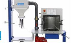
1 record repide pour connexion eur HM (25), ¿ corps listereux semontables, 3 echelle gredues, 4 plaque sive différentes surfaces, 5 ejustage vertical de la plaque, 6 tube de Pitot avec vis micrométriqu pour l'ajustage horizontal
