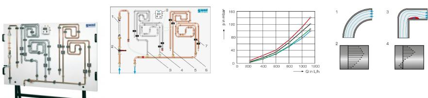
Dans les tuyaux traversés par un écoulement, en plus des pertes de charge suite au frottement du tuyau, on observe également des pertes de charge au niveau des changements de direction de tuyau.
