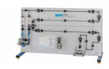
Dans des tuyaux traversés par un écoulement, des pertes de charge ont lieu suite au frottement entre les parois du tuvau et le fluide.
