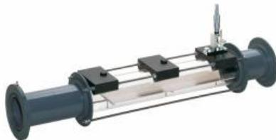
Ce qu'on appelle couche limite se forme le long d'une surface d'un corps soumis à un écoulement incident par l'adhésion du fluide qui s'écoule, par ex. l'air.
