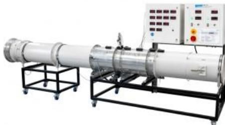
Les soufflantes axiales sont connectées en série dans les installations afin d'augmenter la pression. Lorsque deux soufflantes sont connectées en série, la augmentation de la pression est théoriquement multipliée par deux.
