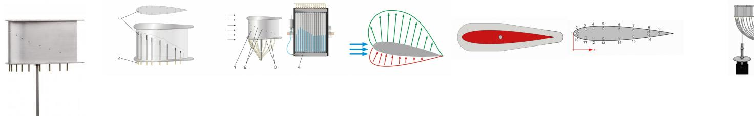
La mesure de la répartition de la pression sur un profil d'aile soumis à un écoulement autour de corps délivre aux étudiants les notions de base sur la génération de la portance effective d'une aile.
