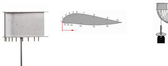
HM 170.26 avec profil d'aile NACA 54118 permet - en liaison avec la soufflerie HM 170 - d'enregistrer la distribution de la pression.
