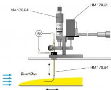
La mesure électronique du déplacement HM 170.61 est un accessoire destiné au système dacquisition des données HM 170.60 et est utilisée lors de l'analyse de la couche limite HM 170.24 afin de détecter électroniquement la position verticale du tube de Pitot.
