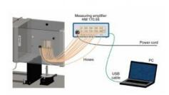
Le système HM 170.55 permet de visualiser la courbe de pression différentielle dans un logiciel.
