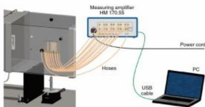
Le système HM 170.55 permet de visualiser la courbe de pression différentielle dans un logiciel.
