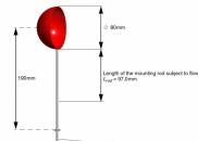
Le corps de résistance coupelle hémisphère est étudié dans la section de mesure de la soufflerie HM 170. Le corps de résistance se compose d'une coupelle hémisphérique en tôle d'acier et d'une barre de maintien en acier inoxydable.
