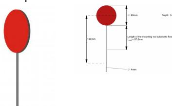
Le corps de résistance disque circulaire est étudié dans la section de mesure de la soufflerie HM 170. Le corps de résistance se compose d'un disque en tôle d'acier et d'une barre de maintien en acier inoxydable.
