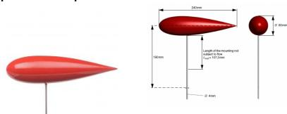
Le corps de résistance corps de ligne de courant est étudié dans la section de mesure de la soufflerie HM 170. Le corps de résistance se compose d'un corps de ligne de courant et d'une barre de maintien en acier inoxydable.
