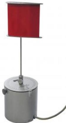
Un corps de portance ou de résistance est utilisé dans le capteur de force HM 170 qui émet la force de traînée et de portance comme valeur mesurée lors de l'écoulement le long du corps.
