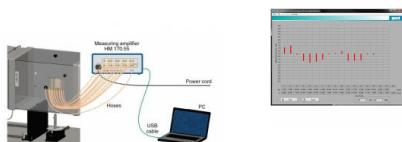
Le système HM 170.55 permet de visualiser la courbe de pression différentielle dans un logiciel.
