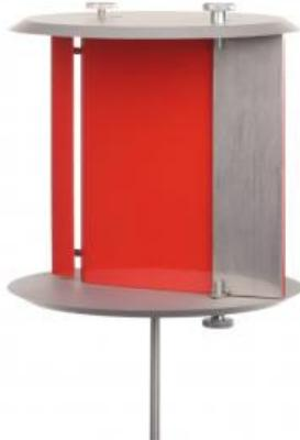
Le modèle d'aile HM 170.21 possède un bec mobile ajustable et un volet d'intrados ajustable à l'extrémité arrière.
