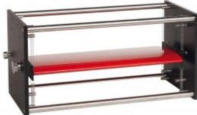
Le modèle à aile est suspendu de façon flexible dans un châssis externe à l'aide de huit ressorts. L'aile peut ainsi effectuer des vibrations torsionnelles et transversales.
