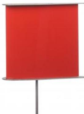
Le corps de portance aile est étudié dans la section de mesure de la soufflerie HM 170.
