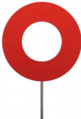
Le corps de résistance anneau de cercle est étudié dans la section de mesure de la soufflerie HM 170. Le corps de résistance se compose d'un anneau de cercle en tôle d'acier et d'une barre de maintien en acier inoxydable.
