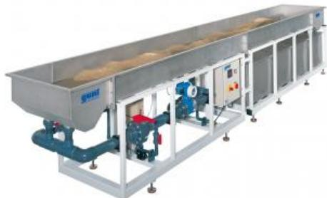
Avec HM 168, des phénomènes importants du transport par charriage dans la zone proche du lit sont montrés avec un écoulement sous-critique.
