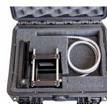
Un système PIV (Particle Image Velocimetry) permet de enregistrer des champs de vitesse dans la section dessai. L'accessoire HM 163.81 contient un système complet avec technique de nappe lumineuse, caméra et synchroniseur. Ce système est adapté aux mesures découlement bidimensionnelles.
