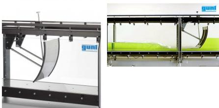
Les vannes radiales font partie des ouvrages de contrôle mobiles; l'écoulement les traverse par dessous. L'élément principal de la vanne radiale est une paroi ayant la forme d'un segment circulaire qui produit une retenue dans un canal traversé par un écoulement.
