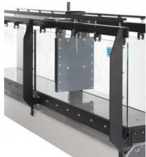
Les vannes planes font partie des ouvrages de contrôle mobiles; l'écoulement les traverse par dessous. Une vanne plane est une paroi verticale qui produit une retenue dans un canal traversé par un écoulement.
