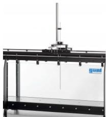
Pour de nombreux essais sur l'écoulement dans des canaux, il est important de connaître la profondeur de l'écoulement.
