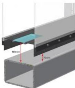
L'accessoire HM 162.83 est une vitre en verre pour le canal dessai HM 162, qui est destinée à être utilisée avec un système PIV, par ex. le HM 162.81.
