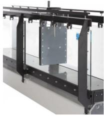
Les vannes planes font partie des ouvrages de contrôle mobiles; l'écoulement les traverse par dessous. Une vanne plane est une paroi verticale qui produit une retenue dans un canal traversé par un écoulement. Les vannes planes sont souvent utilisées pour garantir une profondeur d'évacuation minimum de l'eau en amont en cas de débit variable, p.ex. pour la navigation.
