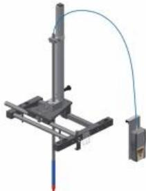
L'élément principal du tachymètre HM 162.64 est une roue à ailettes qui tourne sous l'effet de l'écoulement.
