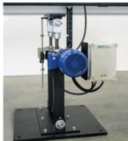
La section dessai du canal dessai du HM 162/HM 163 est inclinable.
