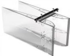
On détermine le débit d'un canal à l'aide de canaux jaugeurs.
