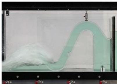
**Analyses la capacité de décharge du déversoir du siphon avec et sans ventilation**
