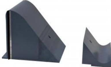
Les déversoirs à crête arrondie sont des déversoirs fixes qui font partie des ouvrages de contrôle. Lorsqu'un corps de déversoir est submergé, il se produit un changement d'écoulement: ce dernier devient supercritique.
