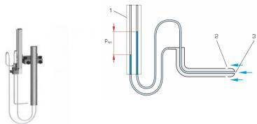
Le tube de Prandtl HM 160.50 est un dispositif de mesure de la vitesse découlement dans le canal dessai HM 160. Il mesure la pression statique et la pression totale au point souhaité de l'écoulement.
