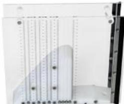
Les déversoirs à crête arrondie sont des déversoirs fixes qui font partie des ouvrages de contrôle.
