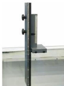
Les vannes planes font partie des ouvrages de contrôle mobiles; l'écoulement les traverse par dessous. Une vanne plane est une paroi verticale qui produit une retenue dans un canal traversé par un écoulement. Les vannes planes sont souvent utilisées pour garantir une profondeur d'évacuation minimum de l'eau en amont en cas de débit variable, p.ex. pour la navigation. L'ouverture de la vanne plane HM 160.29 et donc la décharge en dessous de la vanne peut être réglée manuellement.
