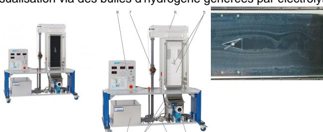
Les petites bulles de gaz sont idéales pour visualiser les champs d'écoulement.
