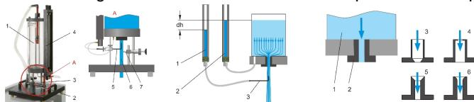
Les pertes de charge lors de la vidange sont liées principalement à deux processus: la déviation du jet à l'entrée dans l'orifice et le frottement des parois dans l'orifice.
